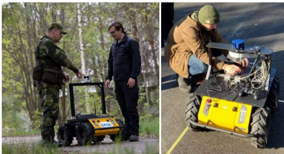
Figur 3: De två UGV:er som projektet för närvarande förfogar över. Den äldre UGV:n, till vänster, har en framåtriktad kamera som kan användas för spaning och "follow me"-funktionalitet. Den har även en 32-linjers LiDAR (laserradar) som används för hinderundvikande och kartering. Den nyare UGV:n, till höger, har bättre spaningsförutsättningar med en 360-graders kamera och en Axis PTZ kameradom.
